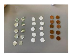
Prima di iniziare a impilare i dischetti abbiamo realizzato una striscia con la carta alluminio sopra la quale abbiamo poi iniziato a creare la nostra pila impilando i dischetti uno sopra l'altro, secondo il rigoroso ordine: per primo il dischetto di alluminio, che è un buon conduttore elettrico, poi quello di scottex, bagnato prima nella soluzione di acqua e sale, e infine la monetina di rame.
