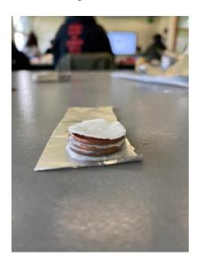
Giunti a termine della fase d'impilamento abbiamo verificato la carica della nostra pila attraverso un multimetro. Il multimetro è un apparecchio formato da un cavo rosso, il nostro polo positivo con il quale toccavamo la monetina in rame, e cavo nero, il nostro polo negativo con il quale toccavamo l'alluminio al di sotto della nostra pila.
